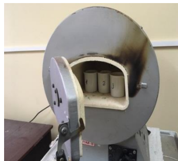
рис. 3 Термическая обработка пробы в муфельной печи
